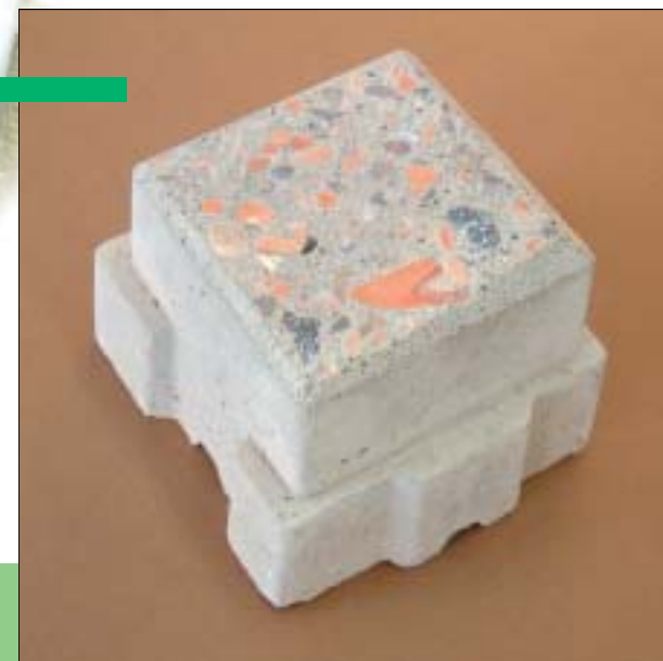
▲廃瓦と鉄鋼スラグを骨材としたテロックの断面
